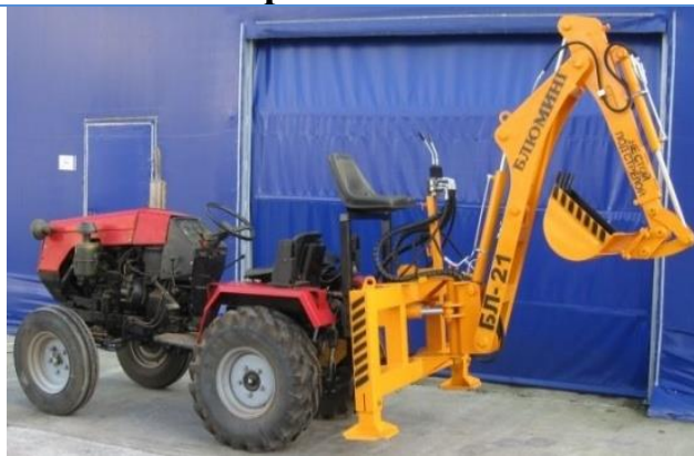
*Экскаватор навесной БЛ-21-250
