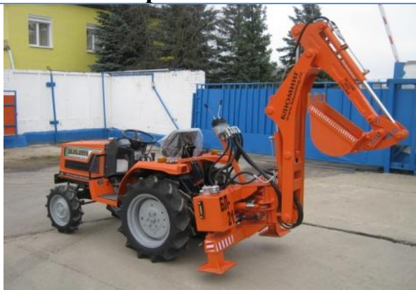
Экскаватор навесной БЛ-21-180
