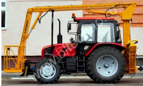
Подъемник БЛ-09 предназначен для пространственного перемещения рабочего в люльке с набором необходимых материалов и инструментов при проведении строительно-монтажных работ.
